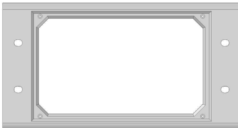
9" 1/2 (42TE) cadre profilé IP vue de face
