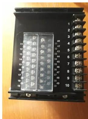
*Les borniers sont recouverts d'un capot transparent de sécurité. Les bornes non utilisées ne doivent pas être raccordées*
