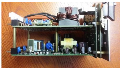
*Le module électronique débrochable est compact, équipé de poignées d'extraction et de vis de verrouillage*
