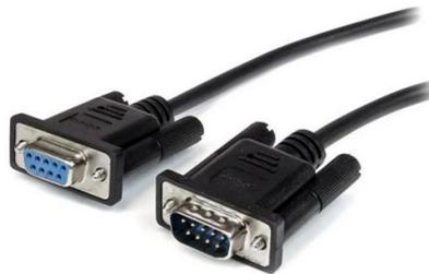
Le côté DB9 mâle se connecte sur le relais UMWH et le côté DB9 mâle ou femelle (selon le PC) se connecte sur l'ordinateur.
