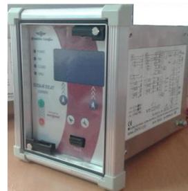
*Le relais **UMWH** se présente dans un boîtier métallique pour être encastré sur une porte.*
