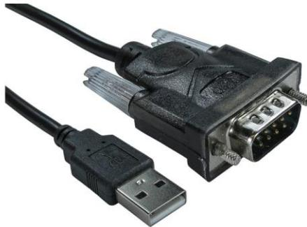
Le côté USB se connecte sur l'ordinateur et le côté DB9 se connecte en face avant du relais UMWH.
