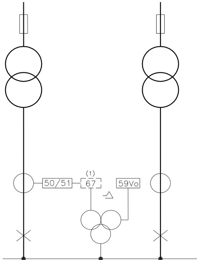
(1) La protection directionnelle (67) est nécessaire seulement si les transformateurs fonctionnent en parallèle.
