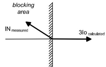
Le principe utilisé par la protection est le suivant : Si l'angle entre le courant résiduel calculé (3Io) et celui mesuré (IN) est supérieur à +/-90° alors la fonction protection terre restreinte peut être bloquée. Pour cela la direction est définie selon le dessin ci-contre.
