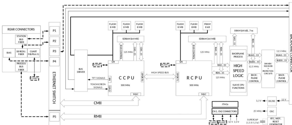
**Schéma fonctionnel CPU****Module CPU****Module CPU**
