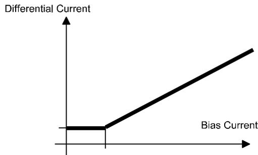
Le bloc fonction évalue en permanence la valeur du courant différentiel qu'il compare au seuil de réglage en considérant l'amplitude de courant qui circule sur chacune des phases, selon une caractéristique à pourcentage (voir ci-contre). Cette courbe de fonctionnement tient compte d'un courant de retenu (Biais) qui est la valeur maximale entre le courant circulant sur chacune des trois phases et le courant dans le neutre
