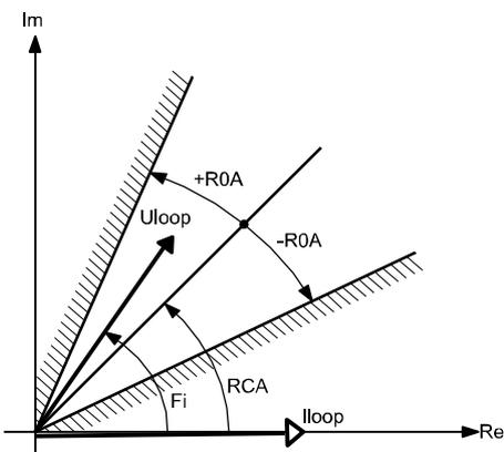
La fonction est activée lors du paramétrage de l'appareil. Un signal d'état issu du bloc fonctionnel VTS (Supervision des Transformateurs de Tensions) peut par ailleurs désactiver le fonctionnement de l'élément directionnel.
