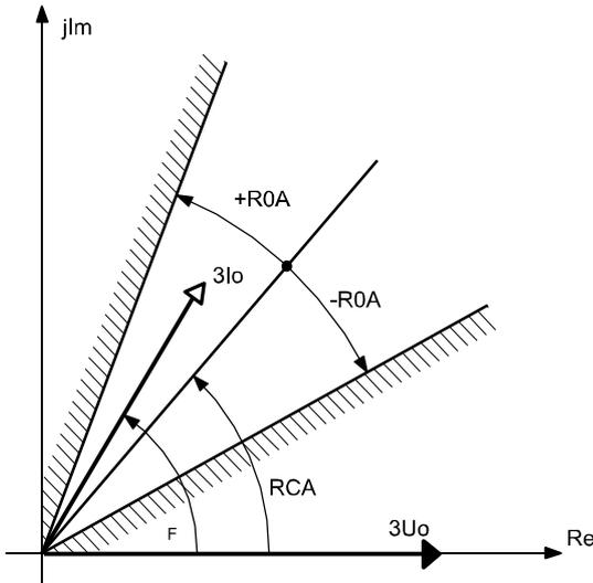
L'élément directionnel émet un signal logique « 1 » si les composantes résiduelles de la tension  $U_N=3U_0$  et de courant  $I_N=3I_0$  sont au-dessus des valeurs nécessaires pour une détermination correcte de la directionnalité et l'angle entre ces vecteurs est compris dans la plage de réglage. La fonction émet un ordre de démarrage au bloc fonctionnel maximum de courant résiduel (TOC51N). Celui-ci est décrit au paragraphe correspondant.
