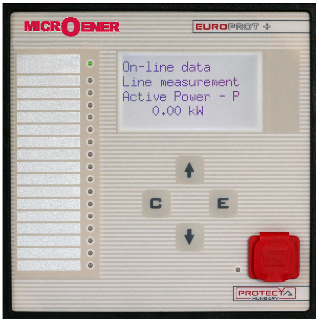
HMI avec afficheur alphanumérique noir et blanc (standard)
