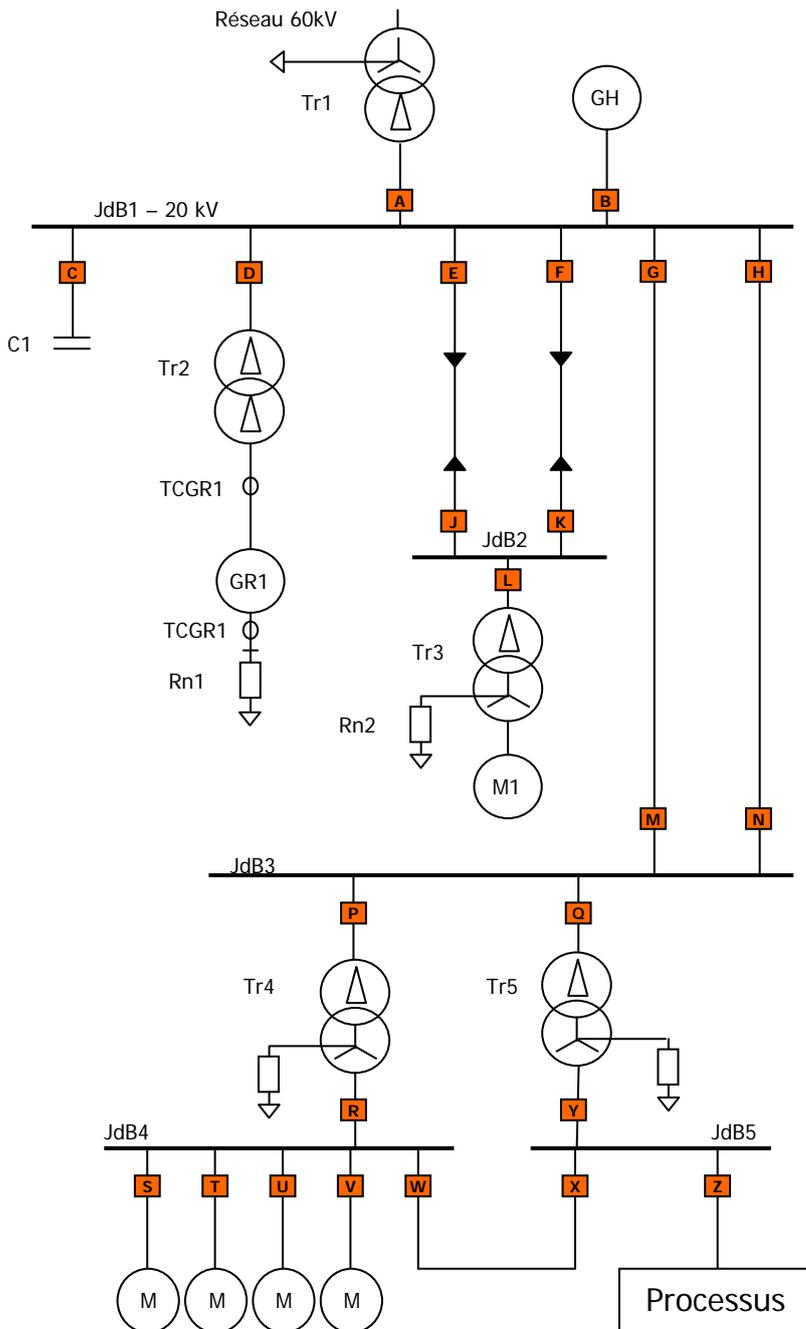
Il ne sera pas tenu compte des charges passives (notamment des moteurs asynchrones) pour le réglage des protections, celles-ci étant variables et entraînant une légère augmentation du courant de défaut.
