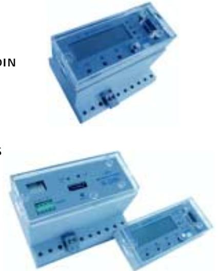
Le relais **N-DIN-TO** est équipé d'une unité ampèremétrique monophasée pour la mesure du courant continu. Il analyse ce courant au travers d'un tore à effet Hall type **TO64** fourni avec le relais de protection..
