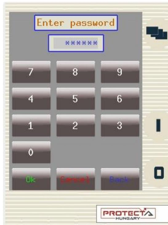
Si le mot de passe est entré correctement, l'indicateur d'état de verrouillage sur la page principale passe à déverrouillé. L'appareil peut également être déverrouillé à partir d'autres éléments de menu, lorsque cette action est nécessaire, comme sur les écrans de paramètres ou de réglages.
