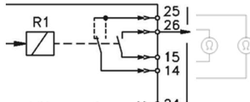
**Montage de Test pour le relais BI2/C**
