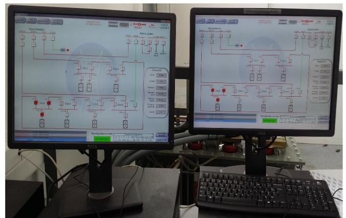
Enfin la solution **SIRACUS 3+** consiste en un ensemble constitué des relais de la série S24 formant **SIRACUS 3**, **associés** à notre système de **supervision MYOSOTIS**. Celui-ci assure entre autres, la conduite du réseau électrique, la synchronisation des horloges des relais, le rapatriement des informations horodatées à la source et des traces oscillographiques, la consignation des états, le journal des événements
