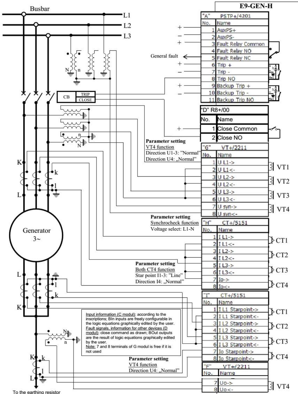
Pour une mesure de la tension homopolaire
