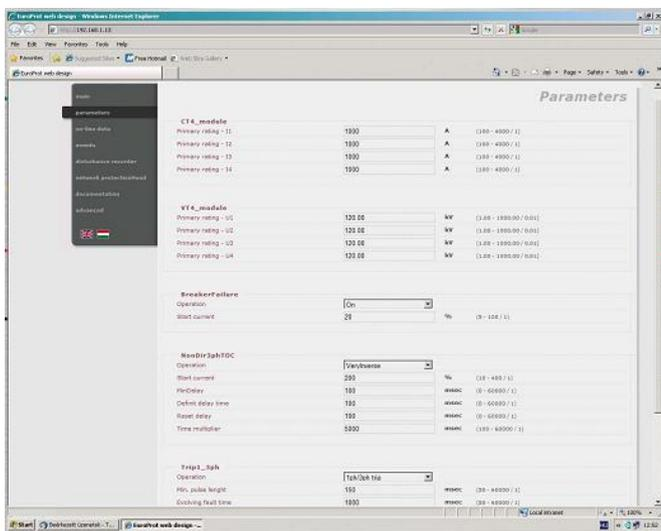
Sans la protection le paramétrage du relais est possible avec le logiciel de configuration EUROCAP.
