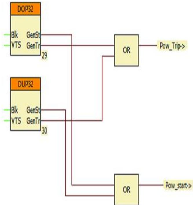
**Logique du bloc fonction Contrôle du Disjoncteur**
