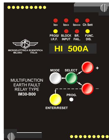
Les **deux unités de mesure** ampèremétriques se raccordent indifféremment au secondaire d'un tore dont le calibre nominal est 1A ou au secondaire de 3 TI dont le calibre nominal est 5A. De plus, les calibres (primaire ou secondaire) des TI raccordés sur les deux unités peuvent être différents.
